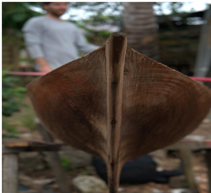
Figura 2: quilla y roda de una esteleadora Emberá. Fuente: Fran Alonso/Proyecto Etnoarqueológico Jāba.
